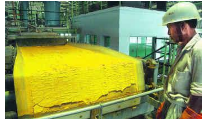
Yellowcake - uranbaserad halvfabrikat som senare blir kärnbränsle
